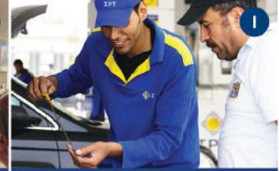
١ فحص مستوى الزيت عن طريق الشيش الخاص بالسيّارة
